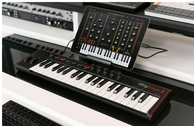
Ил. 11. MIDI-клавиатура (iRig Keys 2), соединенная с мобильным устройством (iPad)
